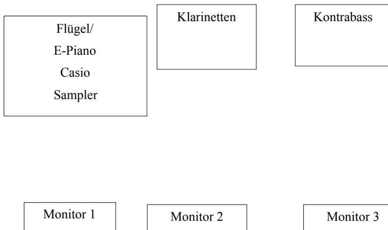
FOH: 16 Inputs über Multicore von einer Stagebox auf der Bühne auf ein digitales oder analoges Mischpult mit Fader, parametrischem EQ und Lowcut je Kanal. 3 Kompressoren auf CH 1-3 oder Stereokompressor auf einer SubGruppe. Hall und Delay auf sends. Zentral vor der Bühne. PA dem Lokal angepasst.
